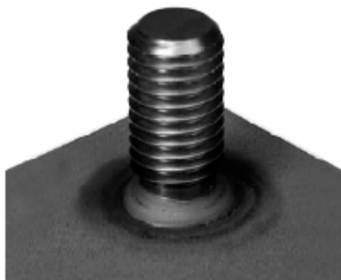
ívhúzásos csaphegesztés védőgáz használata mellett
