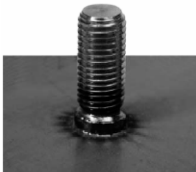
ívhúzásos csaphegesztés kerámiagyűrű használata mellett
