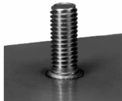
rövidciklusú ívhúzásos csaphegesztés védőgáz használata mellett.
