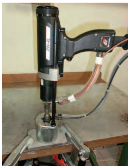
4. ábra: SRM-hegesztőpisztoly M16 hegesztőcsaphoz –technológia illesztése hegesztőpisztolyhoz és a hegesztőfejhez is alkalmas, helyhez kötött alkalmazás esetén is
