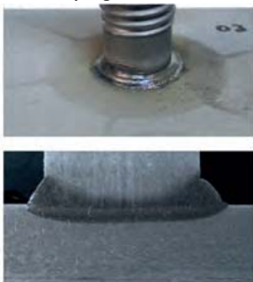
7. ábra: különböző ívhúzásos csaphegesztési variánsok összehasonlítása M12 hegesztőcsappal S235 (5.8 szilárdsági osztály); összes csap ugyanabból a gyártásból való, munkafelület alapanyag: S355, 10 mm vastagság
