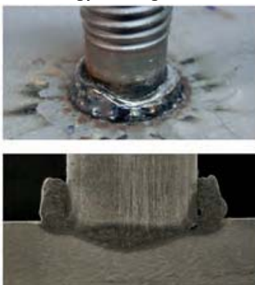
7. ábra: különböző ívhúzásos csaphegesztési variánsok összehasonlítása M12 hegesztőcsappal S235 (5.8 szilárdsági osztály); összes csap ugyanabból a gyártásból való, munkafelület alapanyag: S355, 10 mm vastagság
