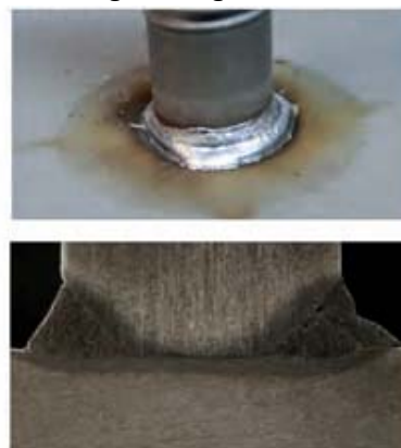
7. ábra: különböző ívhúzásos csaphegesztési variánsok összehasonlítása M12 hegesztőcsappal S235 (5.8 szilárdsági osztály); összes csap ugyanabból a gyártásból való, munkafelület alapanyag: S355, 10 mm vastagság
